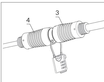
Führen Sie das Kabel durch die Löcher im Adapter und im Stecker und schließen Sie das Vorhängeschloss mit dem TSA-System (Travel Sentry Approved) mit einer dreifachen Zahlenkombination. Die Verwendung eines solchen Vorhängeschlosses erfordert nicht das Mitführen eines Schlüssels, der leicht verloren gehen kann.
