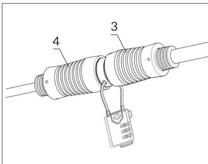
Før ledningen gjennom hullene i adapteren og plugg og lås hengelåsen med TSA-systemet (Travel Sentry Approved), med en trippel kombinasjonskode. Bruken av en slik hengelås krever ikke å bære en nøkkel, som lett kan mistes.
