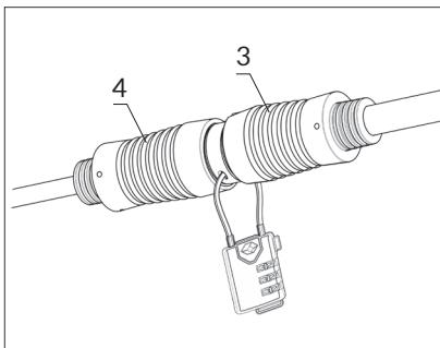
Przez otwory znajdujące się w adapterze i wtyczce należy przełożyć linkę i zamknąć kłódkę z systemem TSA (Travel Sentry Approved), z potrójną kombinacją szyfrową. Zastosowanie takiej kłódki nie wymaga noszenia kluczyka, który można łatwo zgubić.
